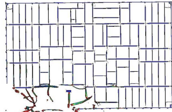
(d) Floor 81 core framing damage
