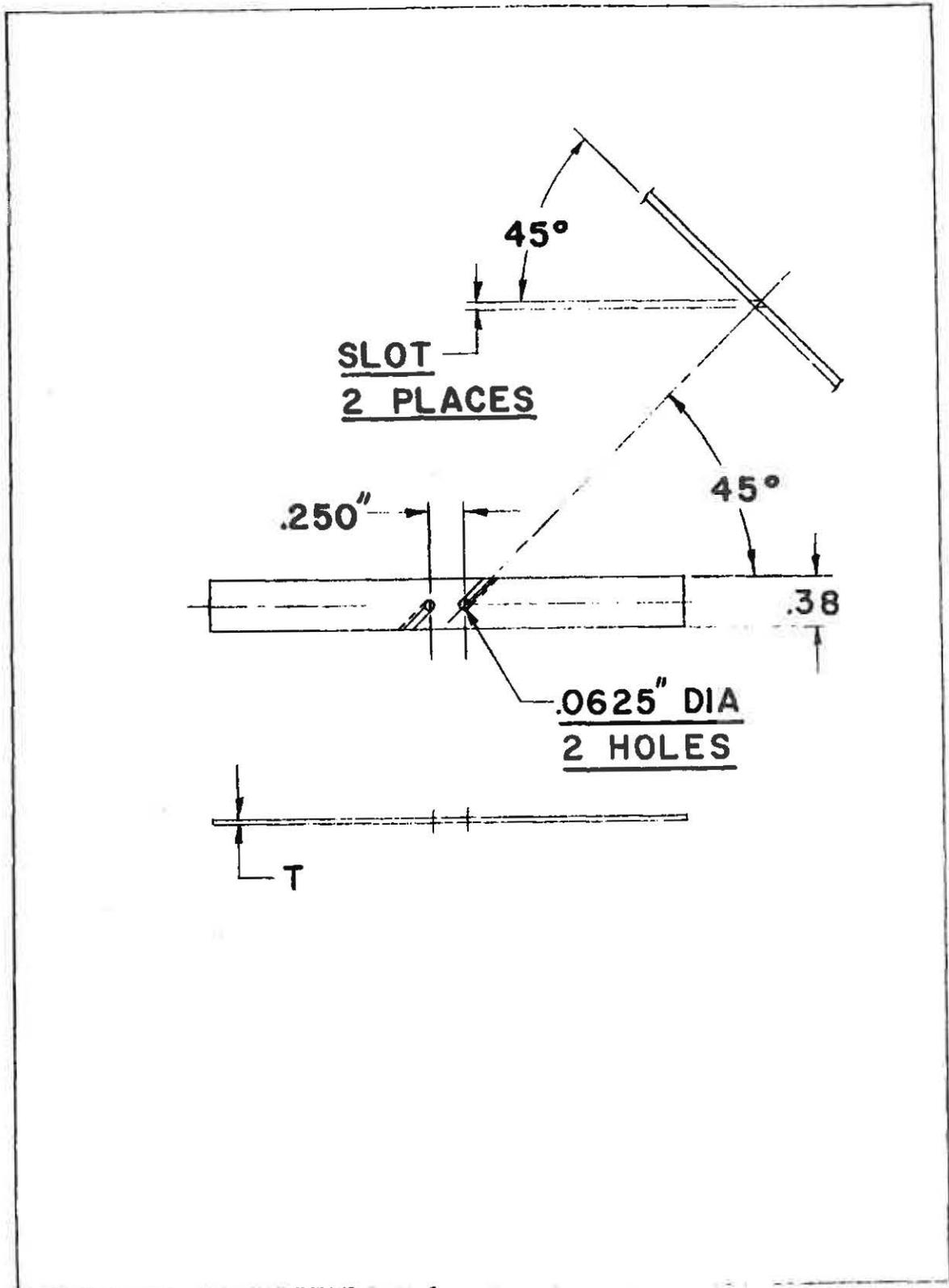
FIGURE 6 SHEAR TEST SPECIMEN
