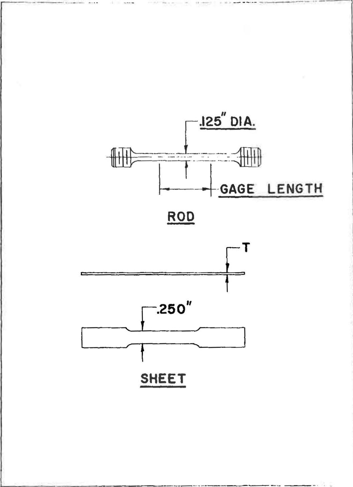
FIGURE 4 TENSILE TEST SPECIMENS
