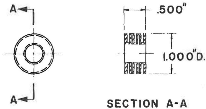
FIGURE 11 BELLOWS TEST SPECIMEN
