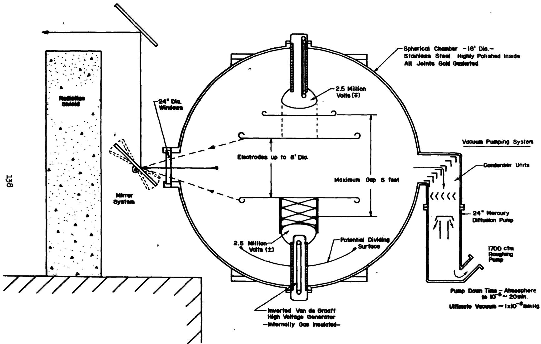
Fig. 34 - 4 MILLION VOLT VACUUM BREAKDOWN FACILITY
